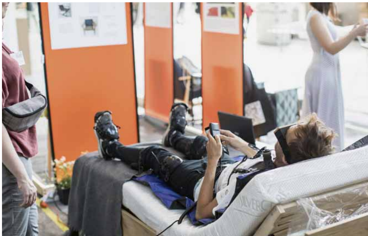
Wykorzystanie maty sensorycznej pozwalającej na obliczenie współczynnika komfortu leżyska
